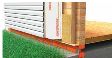
непосредственно по слою утеплителя. Для того чтобы излишки влаги испарялись из конструкции, необходимо оставить между мембраной и наружной обшивкой вентилируемый зазор в 3–5 см. При необходимости может быть изготовлена с применением огнезащитных добавок (антипиренов) для защиты ее от случайных локальных возгораний.
